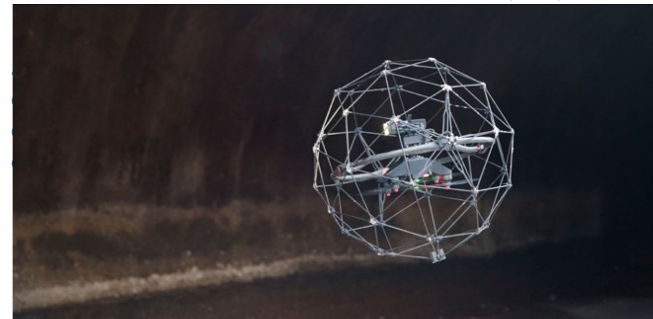
Dron fent una inspecció a una canonada.
