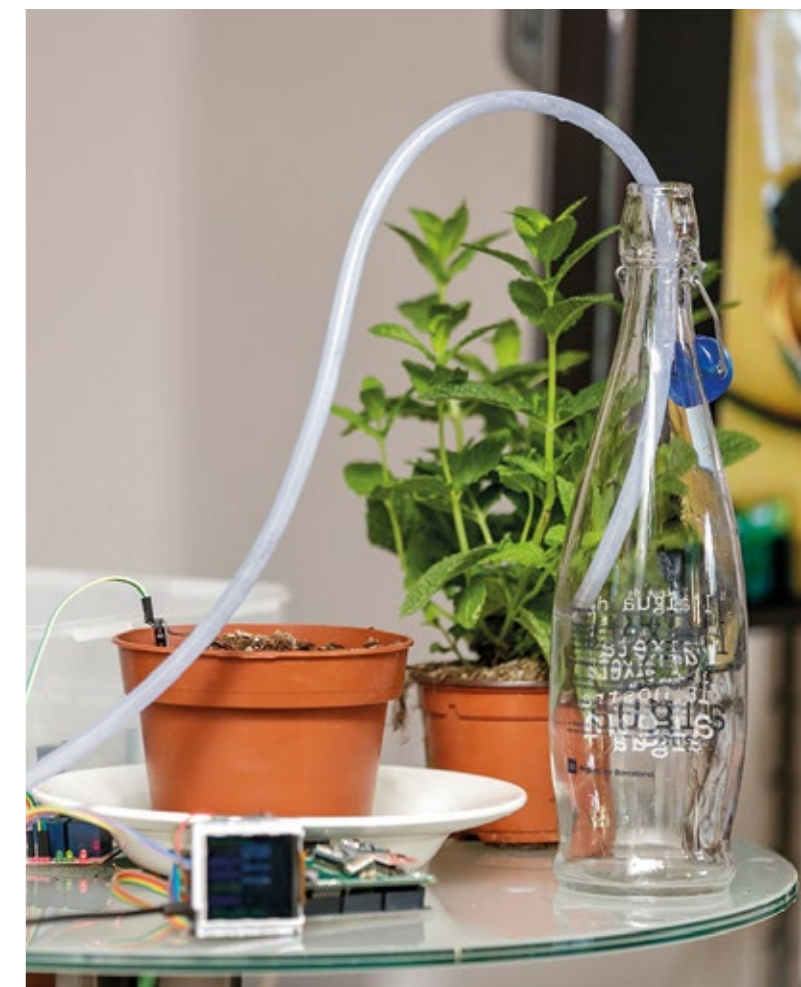
Reg automàtic amb Arduino i sensor d'humitat.
